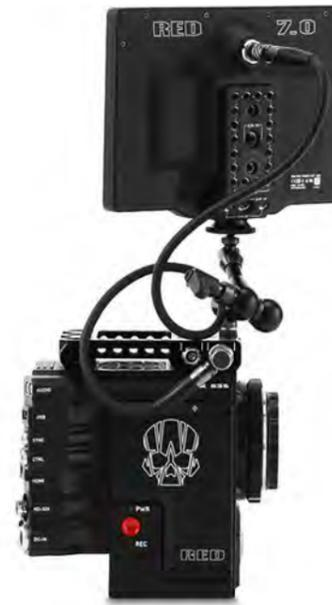
Der ODU MINI-SNAP®, ein runder Push-Pull-Steckverbinder mit Metallgehäuse, wurde gemäß der Anforderungen von RED in acht Variationen hergestellt.
