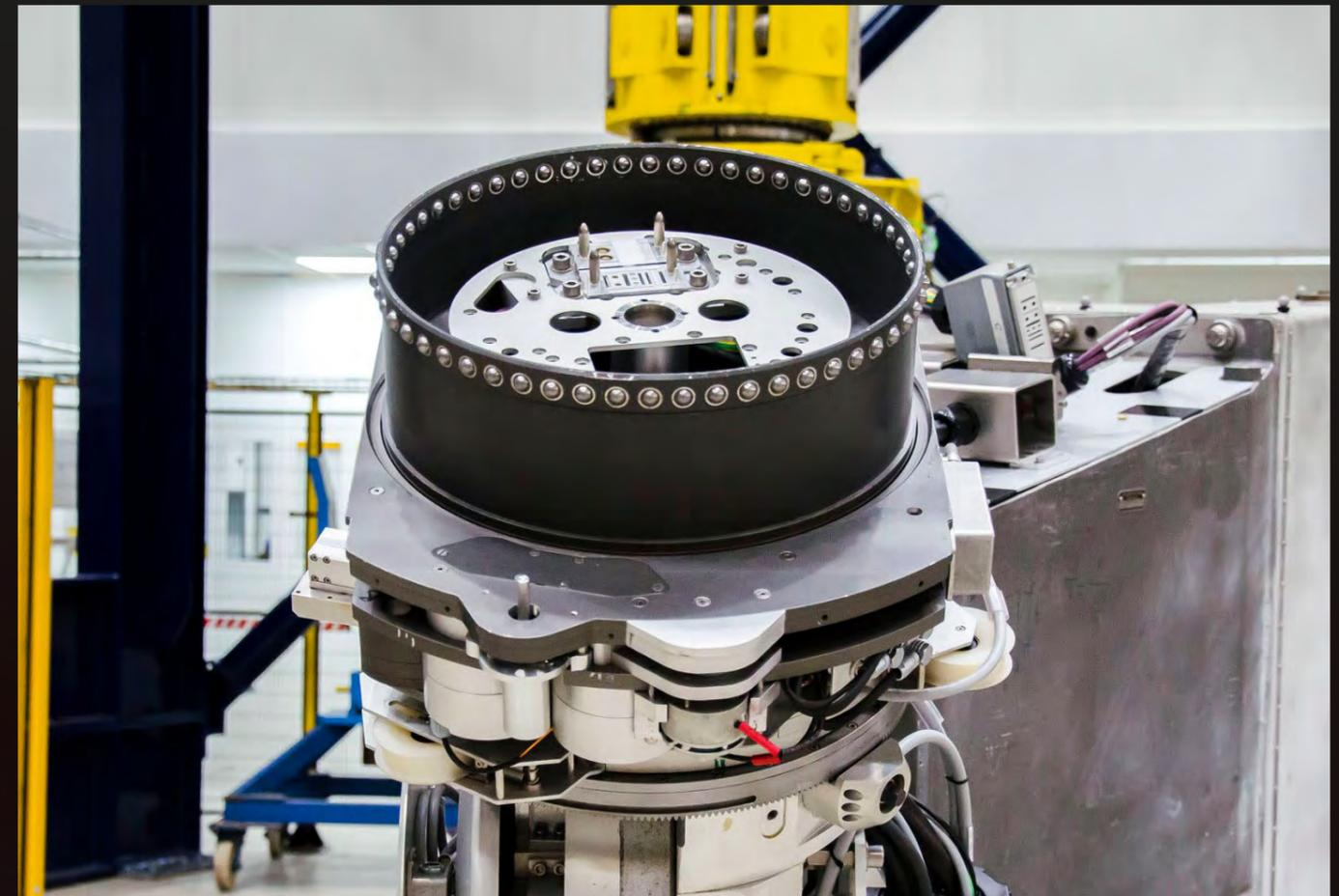
TELESKOP-AUSLEGER MIT **ODU-MAC**® STECKVERBINDERN AN JEDER DER DREI GELENKVERBINDUNGEN
