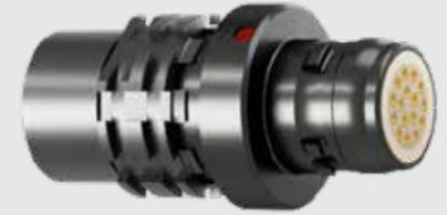
ブレークアウェイプラグ / サイズ 1 / AMC® YRシリーズ / コーディング A / アルミ製コンタクトハウジング、ルテニウムメッキ / 絶縁体PEEK / 16極 / フラットコンタクト (ハンダ) / コンタクト外径 0.6mm / 接続サイズ AWG 26
