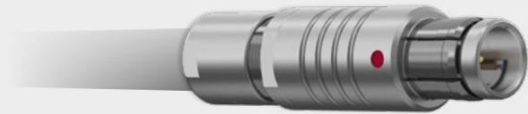
スタイル2 / サイズ2 / Fシリーズ / コーディング1 / コネクタプラグハウジング銅合金マットクローム / 絶縁体PEEK / 16極 / ピンコンタクト（ハンダ） / ケーブルサイズAWG22 / ケーブル径6.5~7 mm / シリコン製バンドリリーフ用バックナット（シリコン製バンドリリーフは別注）
