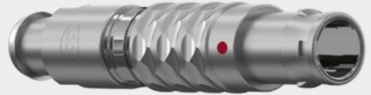
Steckverbinder in Bauform 2 / Baugröße 2 / Serie L / Kodierung 0° / Gehäuse Ms matt verchromt / Isolierkörper PEEK / 16-polig / Stift (Löt) Au / Anschlussquerschnitt AWG 22 / Kabeldurchmesser 6-7,2 mm / Spannmutter für Silikon-Knickschutztülle (Silikon-Knickschutztülle muss separat bestellt werden)
