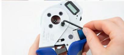
**5** Kontakt mit vorbereitetem Kabel in Crimpstelle einführen. Beachten, dass die Crimpung mittig im Crimpbereich erfolgt (optional: Kontakt vollständig eingeführt in Positionierer).
