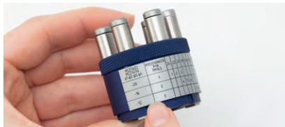
**4** Optional: Positionierer rückseitig auf vorstehende Schraube der Crimpzange setzen und mit Innensechskantschlüssel fixieren. Mit zweitem Schlüssel auf der Vorderseite gegenhalten.
