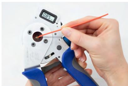
**6** Crimpzange vollständig betätigen. Nach dem Öffnen Kontakt entnehmen und das Ergebnis prüfen.
