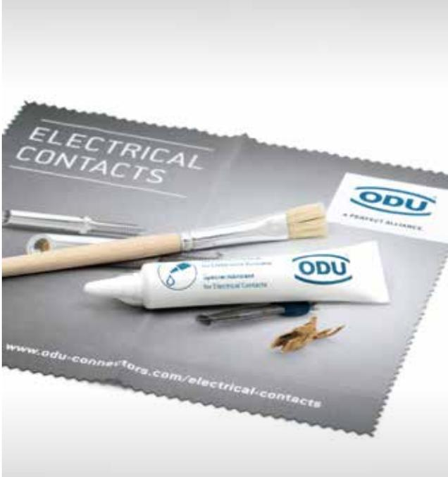
润滑油能有效改善插针的机械性能。我们建议在喷涂润滑油之前先清洁插针表面以便于去除表面杂质。通过适当的维护,可以显著地减小由于频繁插拔而导致的磨损以及减小插入力。清洁与润滑的间隔时间需要根据具体使用环境来确定,这些清洁与润滑的操作必须使用端子生产商推荐的产品。
