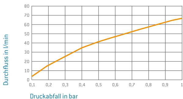
Das Durchflussdiagramm bezieht sich auf die absperrende Variante mit einem maximalen Spalt zwischen Buchsen- und Stiftteil von  $\leq 0,5$  mm. Bei einem veränderten Spaltmaß erhöht sich der Druckabfall.
