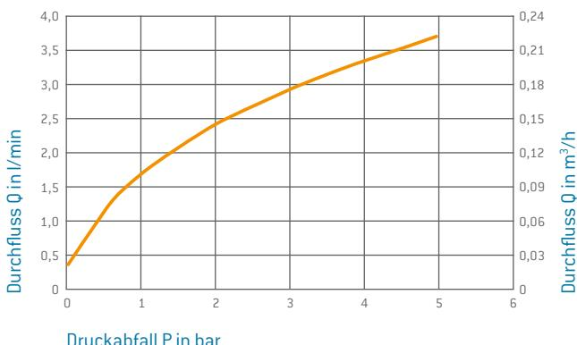
Das Durchflusdiagramm bezieht sich auf die absperrende Variante mit einem maximalen Spalt zwischen Buchsen- und Stiftteil von  $\leq 0,5$  mm.
