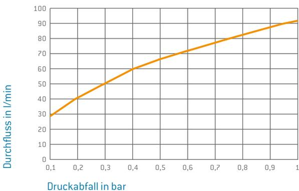
Das Durchflussdiagramm bezieht sich auf die absperrende Variante mit einem maximalen Spalt zwischen Buchsen- und Stiftteil von  $\leq 0,5$  mm. Bei einem veränderten Spaltmaß erhöht sich der Druckabfall.
