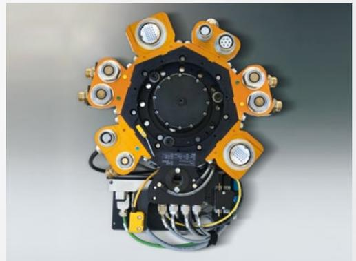
WERKZEUGWECHSLER FÜR INDUSTRIEROBOTER
