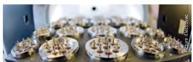
严苛的密封需求 - 例如对密封要求严格的光电设备和电子内窥镜。欧度通过独特的玻璃烧结技术和方案为客户提供更高更多的附加值，例如长久的使用寿命，更多的产品消毒次数以及可靠的材料。
