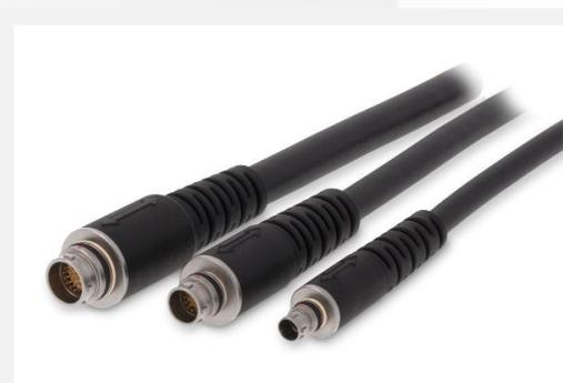
*Il connettore AMC® ad alta densità offre le massime prestazioni in uno spazio di installazione ridotto. È disponibile un tappo a vite aggiuntivo per creare un collegamento resistente con un grado di protezione IP6K8. La robusta codifica meccanica previene i danni causati dalle forze torsionali e consente un accoppiamento senza errori in situazioni estreme.*
